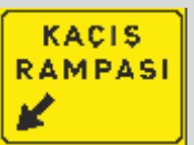
(B-55d) KAÇIŞ RAMPASI (Sağ)
